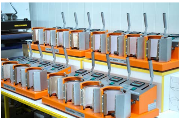
ProfiPress: Aufpressen der Bilder auf die Fototassen
