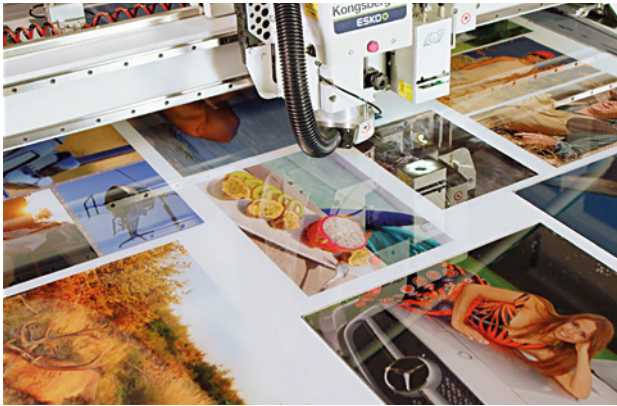
Kongsberg Schneidetisch: Vollautomatischer Zuschnitt der Großformatbilder
