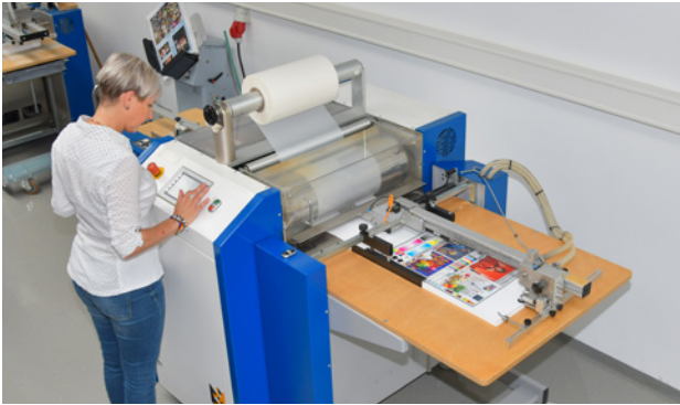
Foliant TLM 500: Zwei Laminiermaschinen verleihen den Titelblättern der Digital- und echtFotobücher den nötigen „Glanz“.
