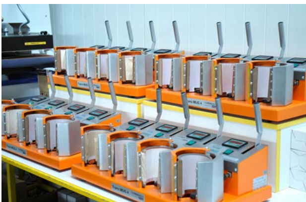
ProfiPress: Aufpressen der Bilder auf die Fototassen
