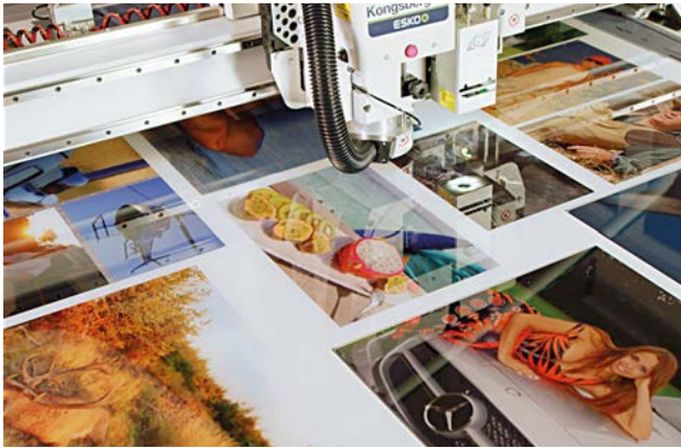
Kongsberg Schneidetisch: Vollautomatischer Zuschnitt der Großformatbilder
