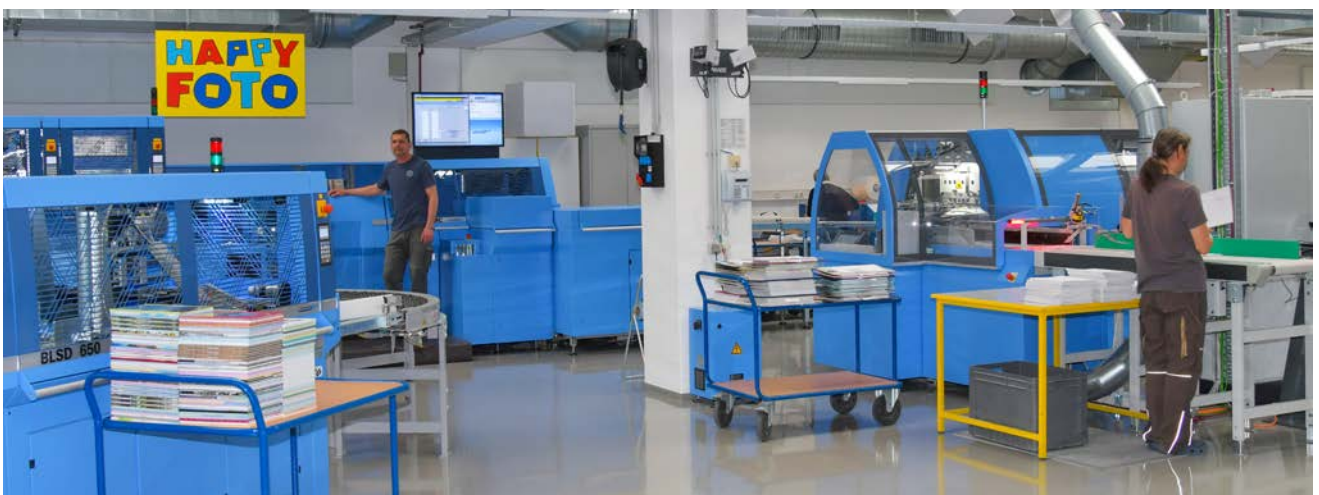
Buchfertigungsstraße: Auf dieser Anlage werden die Buchdecken mit den Buchblöcken vereint. Am Ende kommt das fertige Buch heraus.
